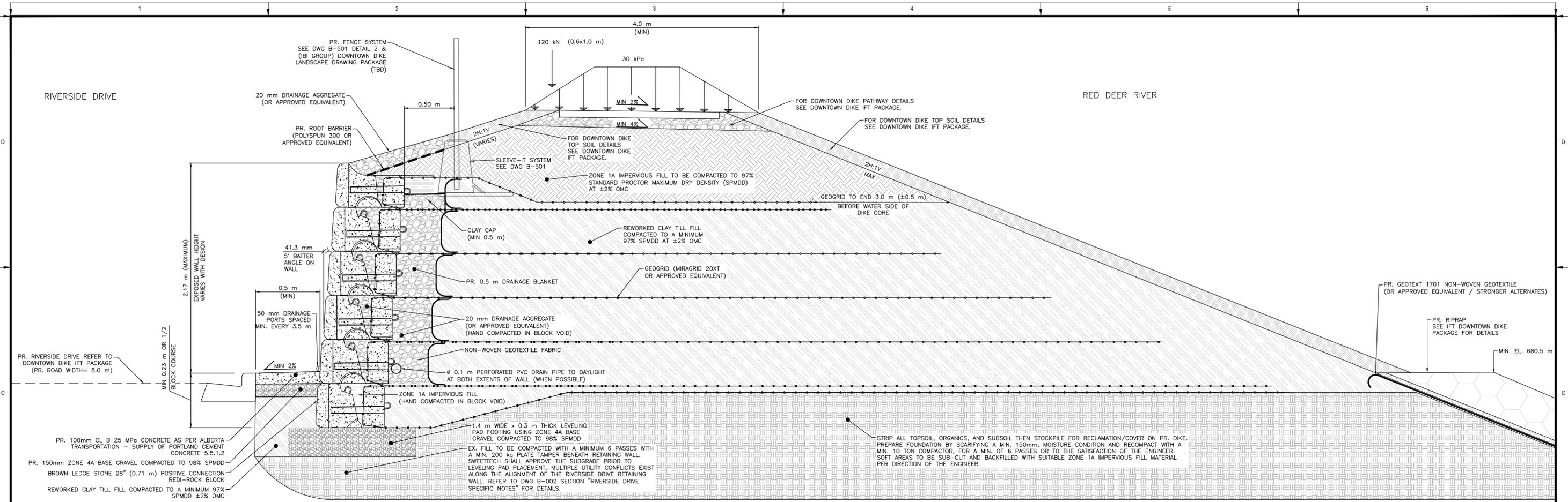
MAXIMUM RIVERSIDE DR. REDI-ROCK GEOGRID REINFORCED RETAINING WALL SECTION
