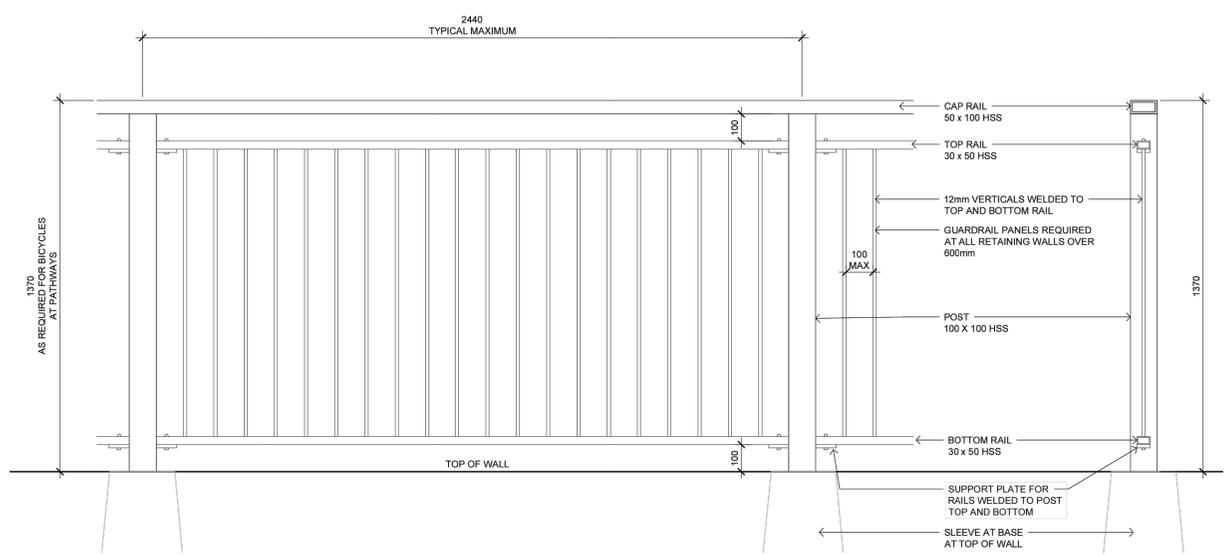
**2 PEDESTRIAN GUARDRAIL AT WALLS OVER 1.0m HT.**
